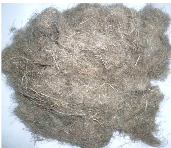
Рис. 5. Вид волокна, полученного из тресты льна-межеумка после первого пропуса
